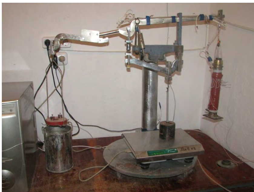
Рисунок 2.2 – Общий вид установки для изучения кинетики карбонизации извести
