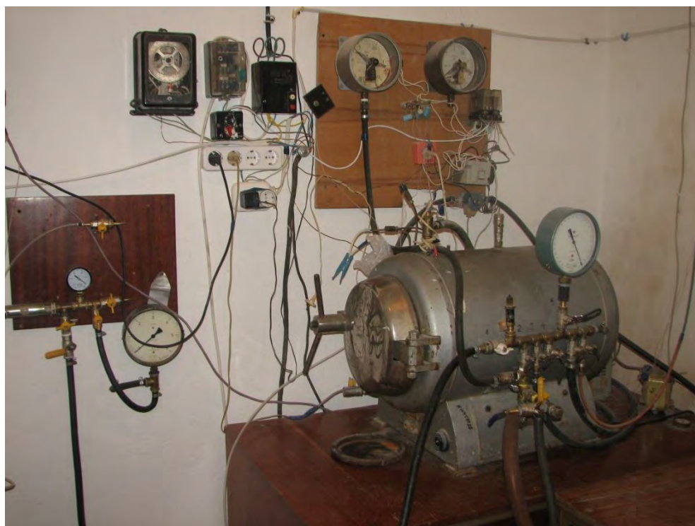
Рисунок 2.10 – Общий вид автоматической установки для изучения процесса карбонизации с основными узлами
