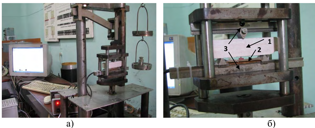
а) – внешний вид аппаратно-программного комплекса; б) – образец в нагружающем устройстве.
